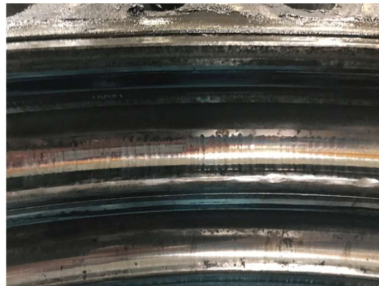
(d) False brinelling and corrosion
