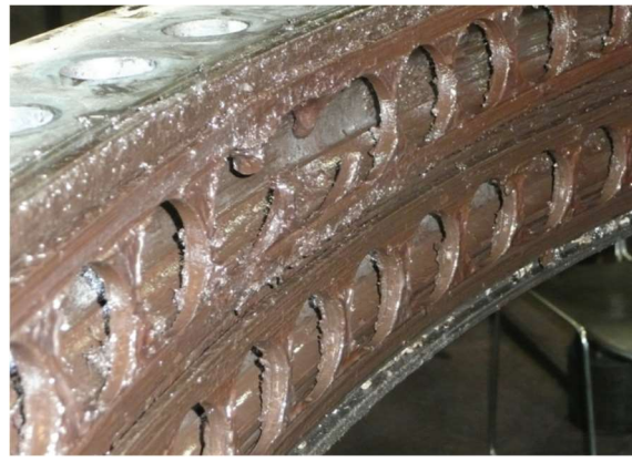
(d) Separator fracture
